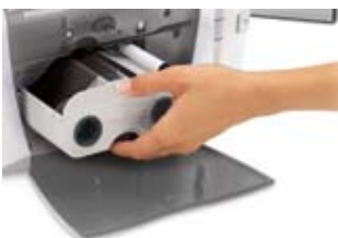
Chargez les rubans en un clin d'œil. La cartouche d'impression tout-en-un de la Persona C30e permet de remplacer à la fois le ruban et le rouleau de nettoyage en une seule et même étape.
